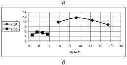
Рис. 3. Зависимость извлечения частиц ( $\epsilon$ ) крупностью +0.315-0.63 мм от скорости подачи пульпы (u) на рабочую поверхность при различных диаметрах насадок d: a)  $d_1=7$  мм;  $d_2=10$  мм;  $d_3=15$  мм; б)  $d_4=20$  мм;  $d_5=27$  мм
